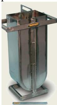
La differenza **H2-H1** è detta **altezza di riempimento**. Se il calcestruzzo fluisce liberamente come acqua, al termine del moto di flusso, si dispone allo stesso livello in entrambi i compartimenti, e l'altezza di riempimento è uguale a 0.
