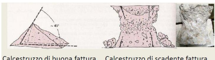
**MODALITÀ ROTTURA PROVINI CILINDRICI:** Anche per i provini cilindrici la rottura dei provini, a 28 gg dal confezionamento, dovrebbe avvenire in modo uniforme simmetrico senza lesioni sulle facce del provino che toccano i piani della pressa, come di seguito riportato:
