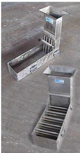
Le sezioni delle barre possono essere diverse e poste ad interassi diversi, per imporre una prova più o meno severa alla mobilità in spazi ristretti del calcestruzzo. Quando il flusso si è arrestato, si misura l'altezza del cls in corrispondenza del fondo del tratto verticale **H2** e nella sezione finale del tratto orizzontale **H1**, valutando il **rapporto di bloccaggio H2/H1**.
