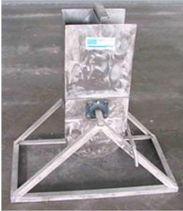
La misura dello **scorrimento confinato** può essere effettuata con la **scatola ad U**. Lo strumento consiste di un condotto a sezione rettangolare che è diviso in due compartimenti da una botola mediana sollevabile. Una griglia, composta da barre di diametro  $\Phi$  13 mm ad interasse di 50 mm, è posta tra i due compartimenti, creando uno spazio di 35 mm tra le barre.
