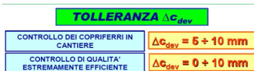
Consideriamo una trave di un edificio in classe ambientale **XC1** da armare con staffe  $\Phi 8$  e con barre longitudinali  $\Phi 16$ . La classe del cls è **C25/30** e la dimensione massima degli inerti è pari a **20 mm**. Si procede al calcolo del copriferro nominale delle staffe.
