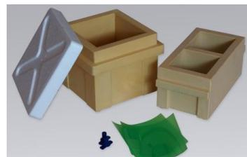
**DIMENSIONI CUBETTI:** In Italia la misura della resistenza caratteristica è eseguita generalmente su *provini cubici*, le cui dimensioni sono codificate dalla UNI 6130 in funzione della dimensione massima dell'inerte  $D_{max}$ .
