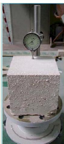
Apparecchiatura per la verifica della planarità delle facce
