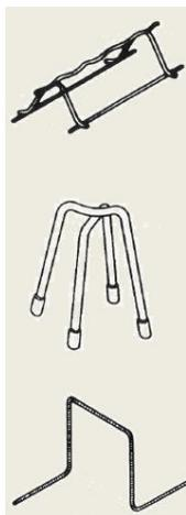
□ **cavallotti lineari**, posti a distanza massima di 50 volte il diametro della barra, che poggeranno sul reticolo inferiore qualora esista o su distanziatori puntuali lineari ad interasse massimo di 50 cm;
