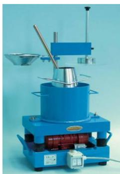
Si fissa il contenitore sulla tavola di Abrams e lo si colloca nel fondo del contenitore mediante il pestello. Si compattava il calcestruzzo con il pestello, quindi, si svincola il cono dal fondo del contenitore cilindrico e lo si solleva verticalmente servendosi delle maniglie. Una volta sformato il calcestruzzo nel contenitore, si colloca sopra la sua superficie superiore il disco trasparente e si registra l'abbassamento.
