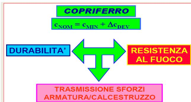
**COPRIFERRO MINIMO:** Lo spessore minimo del copriferro  $c_{min}$  è il valore massimo tra quelli minimi imposti per soddisfare le esigenze di *durabilità*, di *aderenza* e di *resistenza al fuoco*. Il valore minimo del **copriferro** è dato da:
