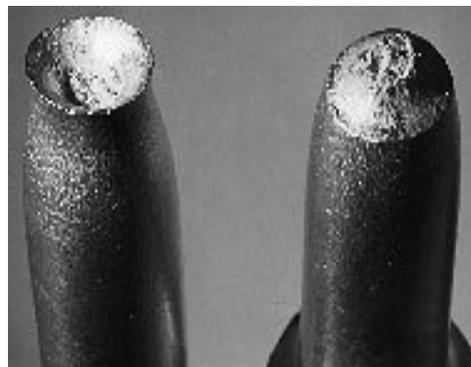
Si hanno fratture di profilo caratteristico, nella fotografia si ha il profilo detto a "tazza e cono", sotto invece si hanno rispettivamente due provini: uno altamente duttile e uno moderatamente duttile.
