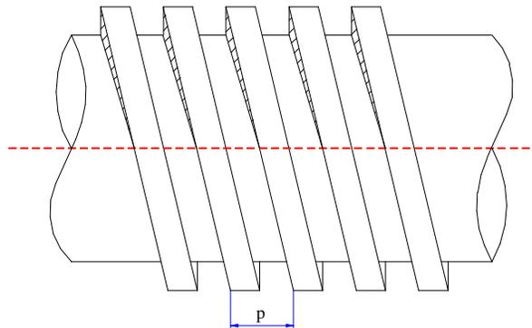
Ad ogni rotazione della vite si ha un avanzamento pari al passo della vite.
